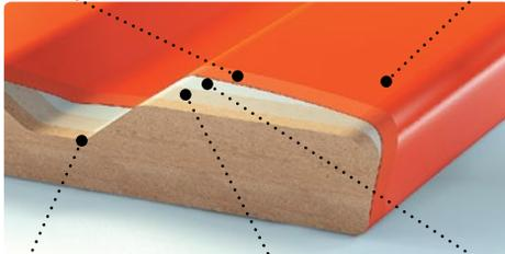
грунт изолятор пигментный грунт фрезеровка по поверхности МДФ
